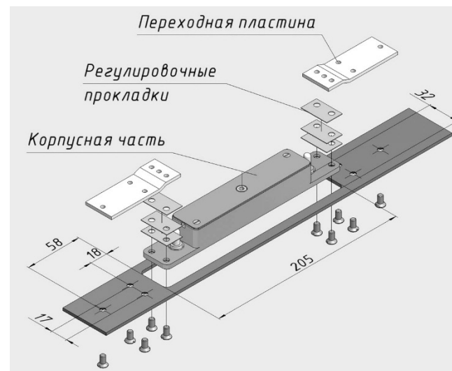
Рис.6 Установка корпуса замка в металлическую коробку.
