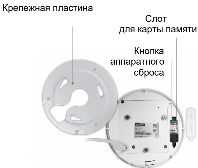
Рисунок 4.2 – Расположение кнопки аппаратного сброса и слота для карты памяти
