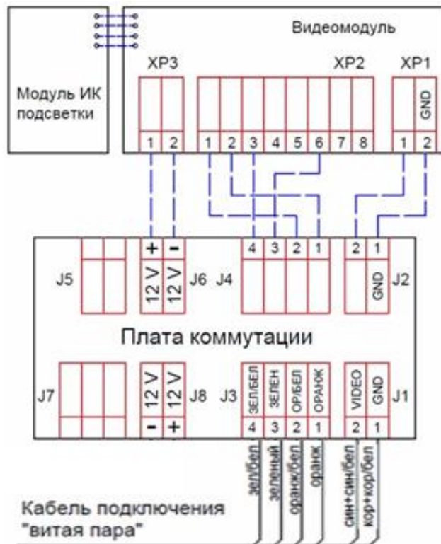
Рисунок 4.6 – Схема подключения камеры с питанием по PoE
