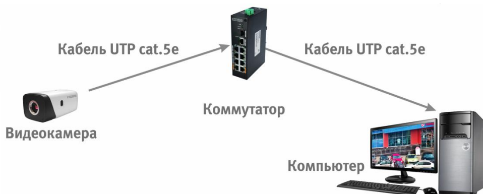
Рисунок 8.3 – Схема подключения видеокамеры к компьютеру через коммутатор
