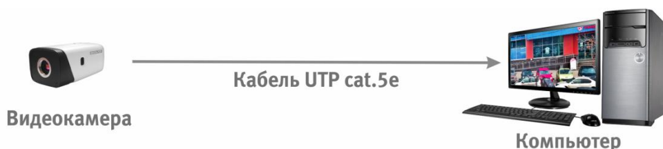
Рисунок 8.2 – Схема подключения видеокамеры к компьютеру
