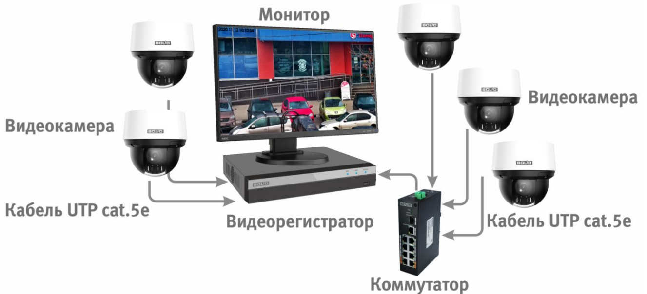
Рисунок 6.4 – Схема подключения видеокамеры к видеорегистратору
