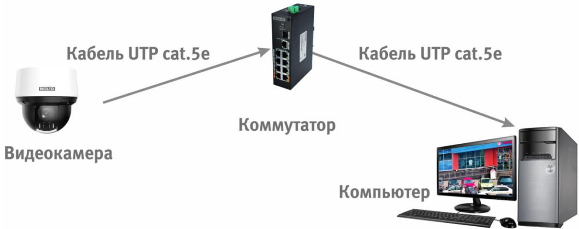
Рисунок 6.3 – Схема подключения видеокамеры к компьютеру через коммутатор
