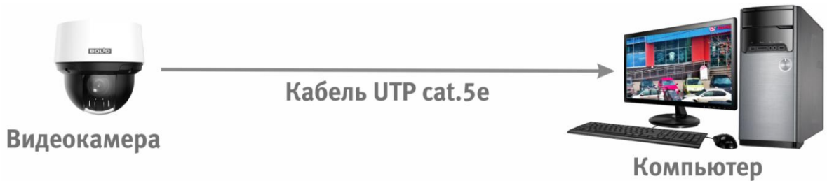
Рисунок 6.2 – Схема подключения видеокамеры к компьютеру
