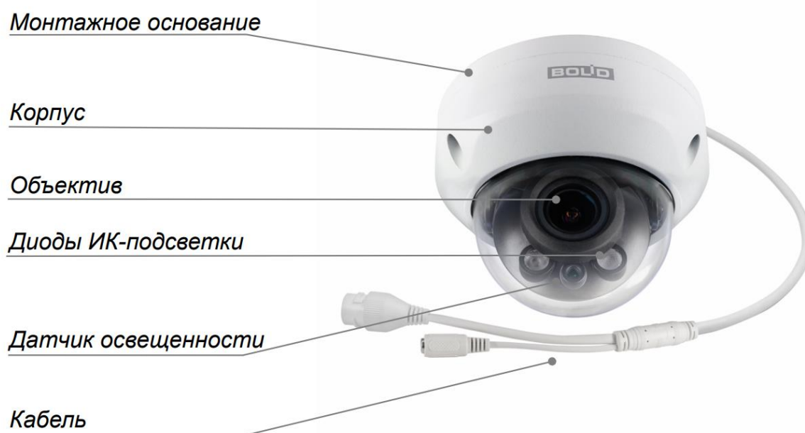
Рисунок 4.1 – Внешний вид и основные элементы видеокамеры
