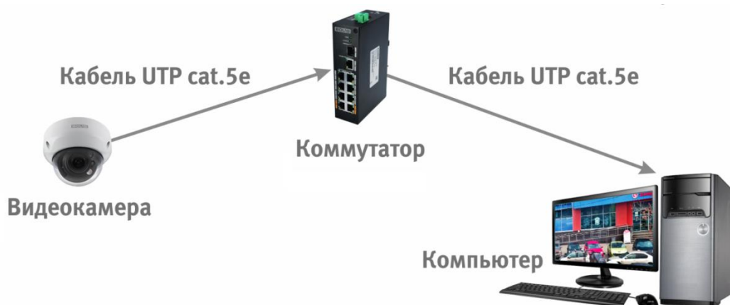
Рисунок 6.3 – Схема подключения видеокамеры к компьютеру через коммутатор
