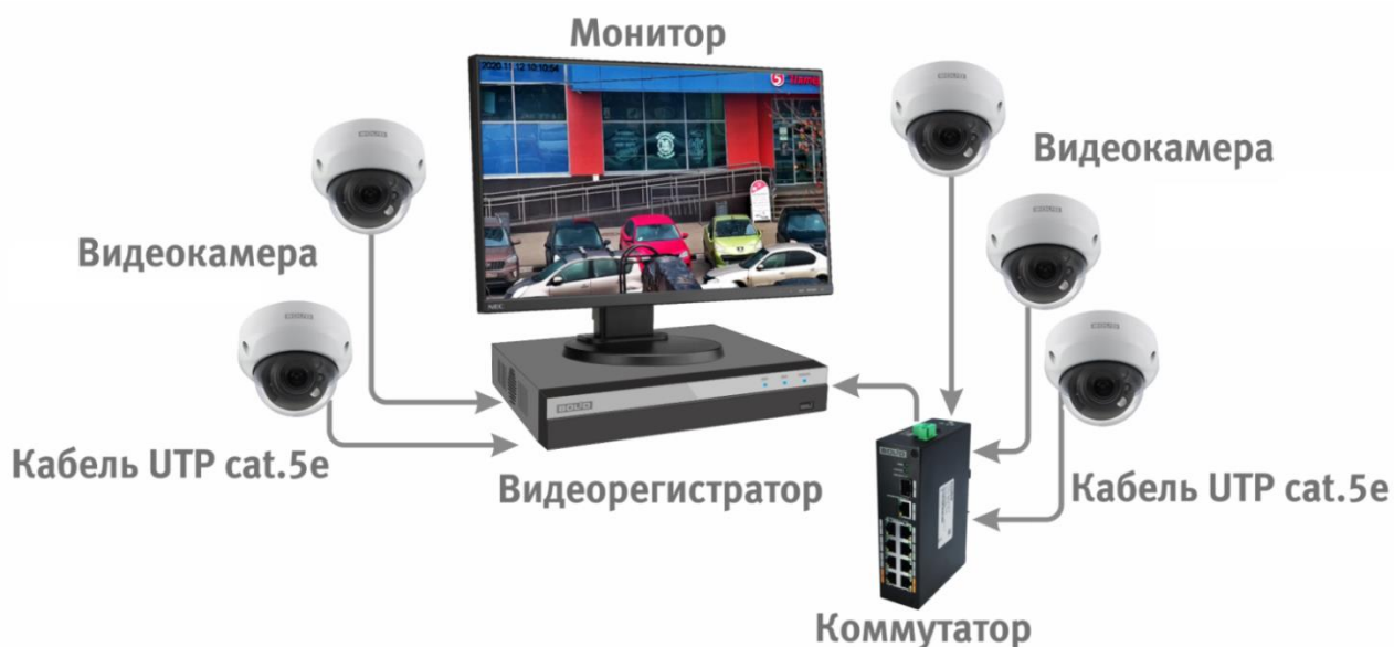
Рисунок 6.4 – Схема подключения видеокamеры к видеорегистратору
