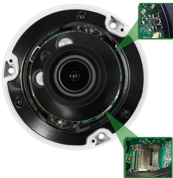
Рисунок 4.2 – Расположение кнопки аппаратного сброса и слота для карты памяти
