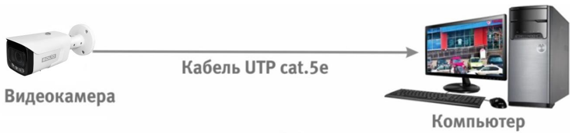
Рисунок 6.2 – Схема подключения видеокамеры к компьютеру
