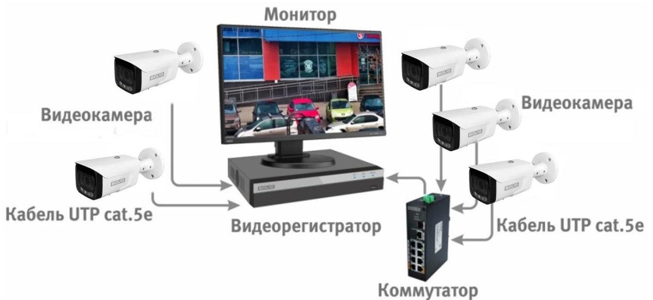
Рисунок 6.4 – Схема подключения видеокамеры к видеорегистратору
