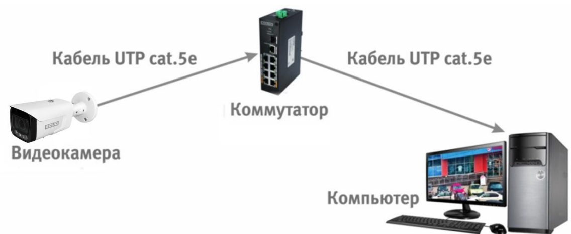
Рисунок 6.3 – Схема подключения видеокамеры к компьютеру через коммутатор
