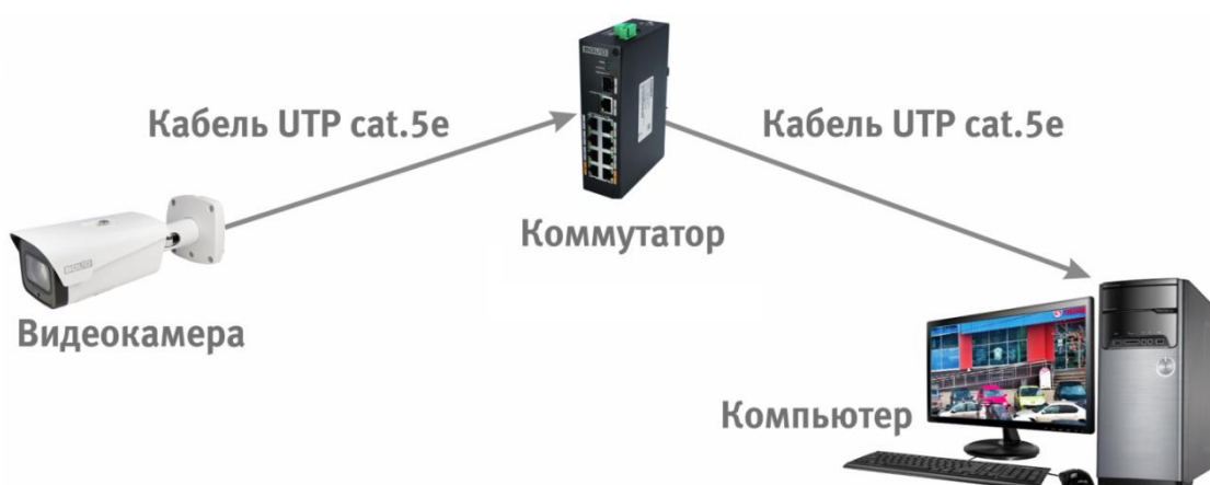
Рисунок 6.3 – Схема подключения видеокамеры к компьютеру через коммутатор
