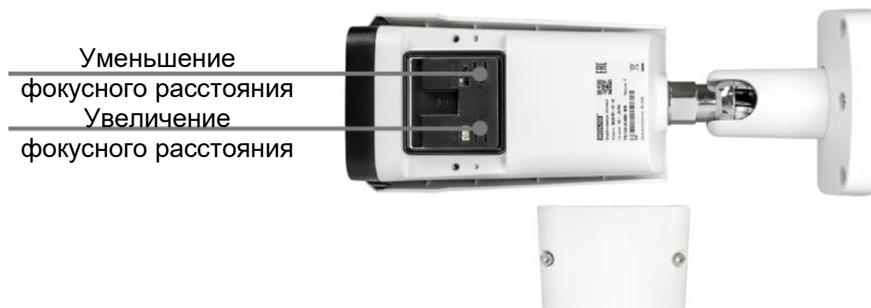
Рисунок 5.14 – Настройка фокусного расстояния вручную
