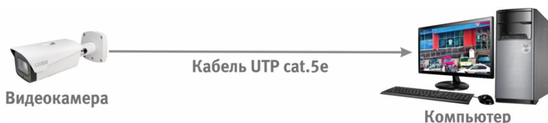
Рисунок 6.2 – Схема подключения видеокамеры к компьютеру
