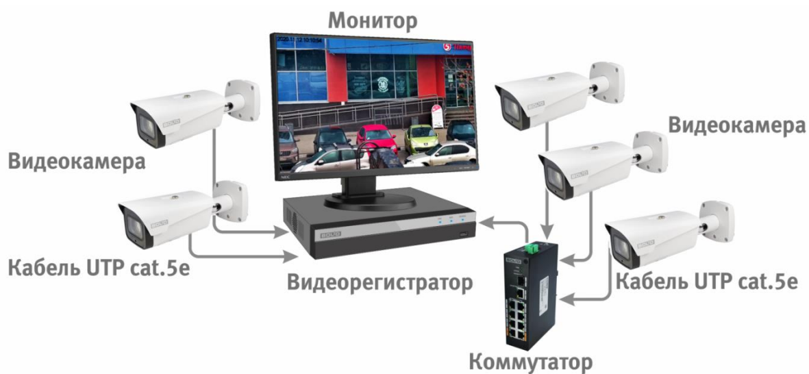
Рисунок 6.4 – Схема подключения видеокamеры к видеорегистратору
