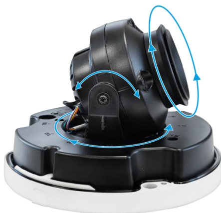
Рисунок 5.20 – Настройка направления объектива
