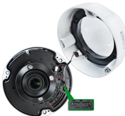
Рисунок 5.19 – Настройка фокусного расстояния вручную
