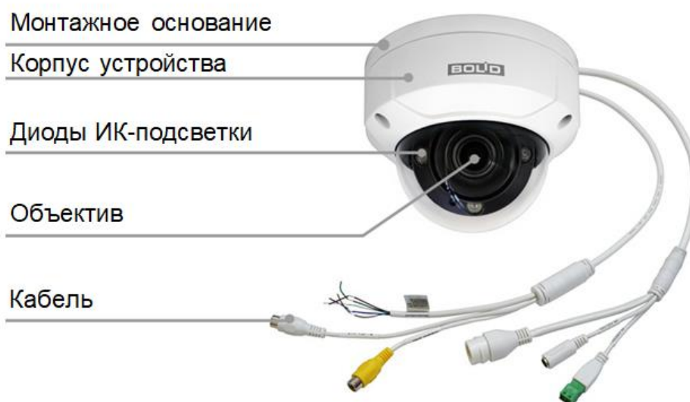
Рисунок 4.1 – Внешний вид и основные элементы видеокамеры
