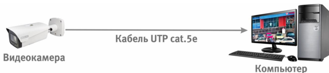
Рисунок 6.2 – Схема подключения видеокамеры к компьютеру
