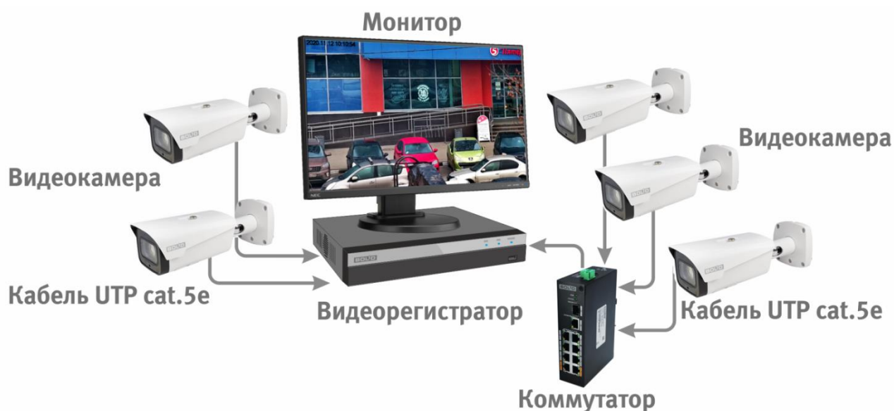
Рисунок 6.4 – Схема подключения видеокamеры к видеорегистратору
