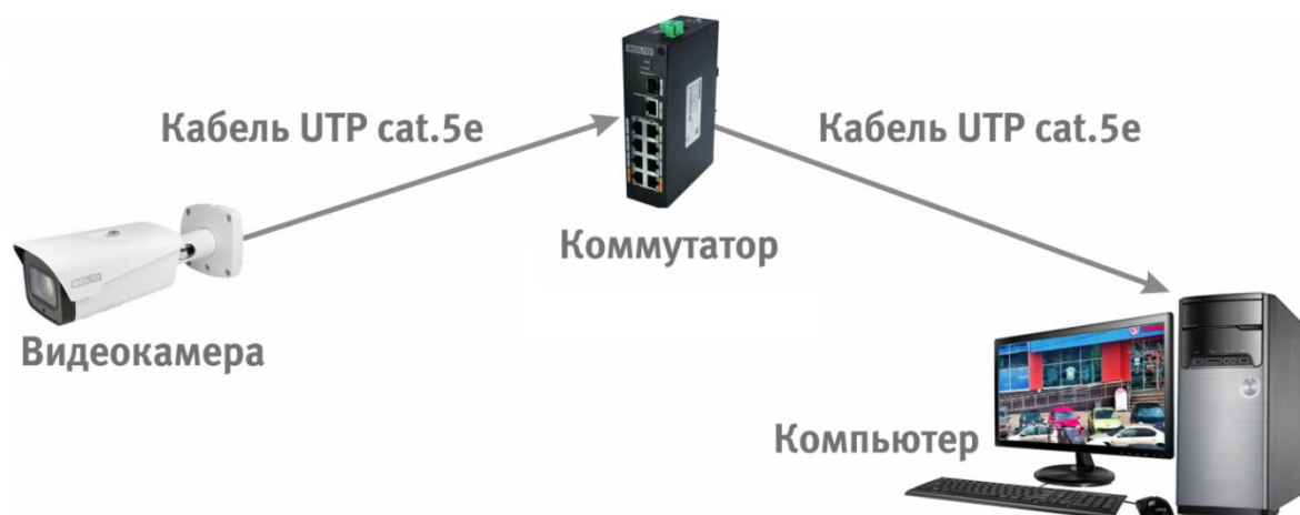
Рисунок 6.3 – Схема подключения видеокамеры к компьютеру через коммутатор
