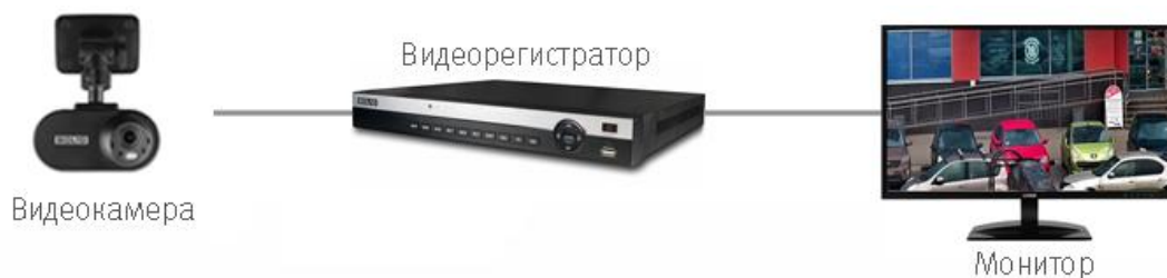
Рисунок 6.2 – Схема подключения видеокамеры
