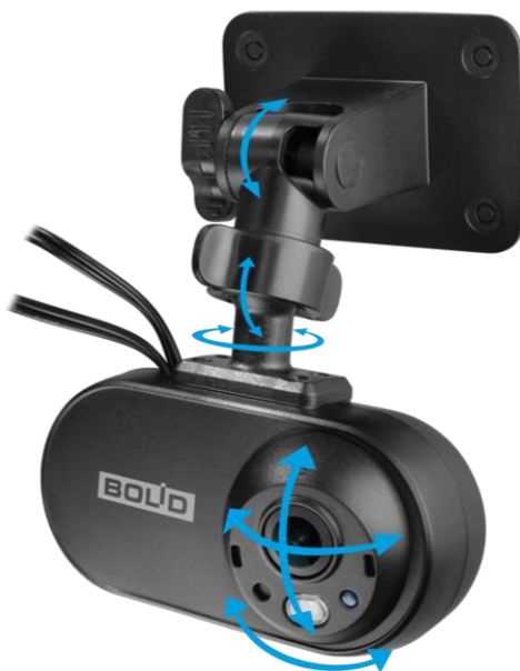
Рисунок 5.3 – Настройка направления объектива
