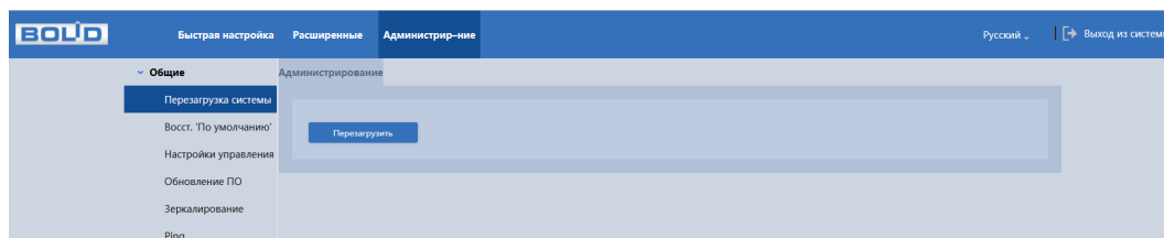
Рисунок 11.12 – Интерфейс программной перезагрузки устройства
