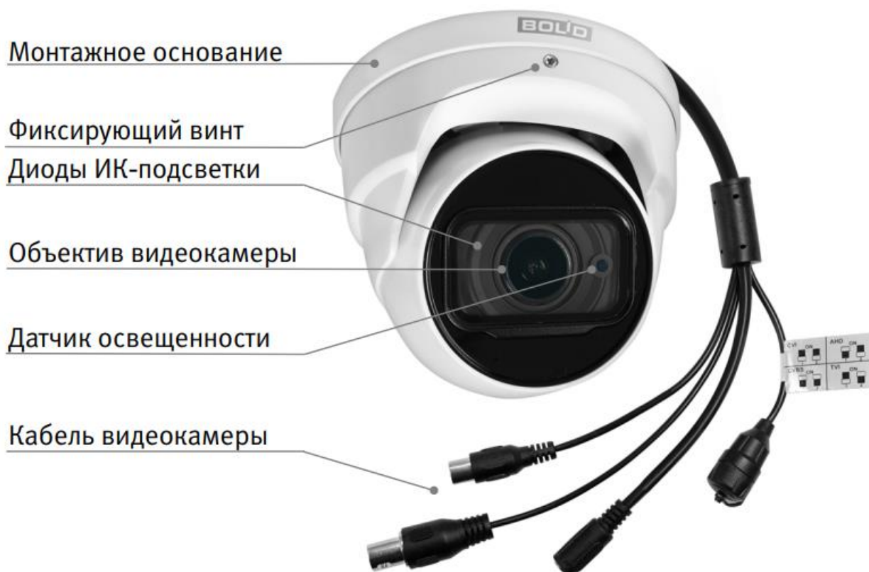
Рисунок 4.1 – Внешний вид и основные элементы видеокамеры
