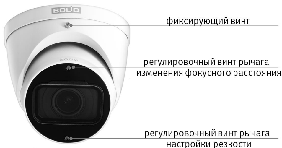
Рисунок 6.4 – Настройка фокусного расстояния и направления объектива
