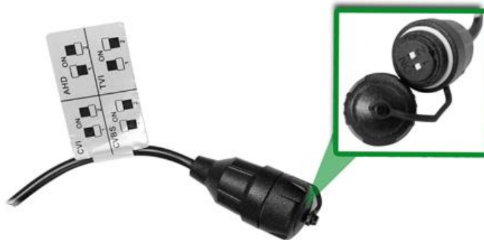
Рисунок 6.3 – Переключатель формата видеосигнала
