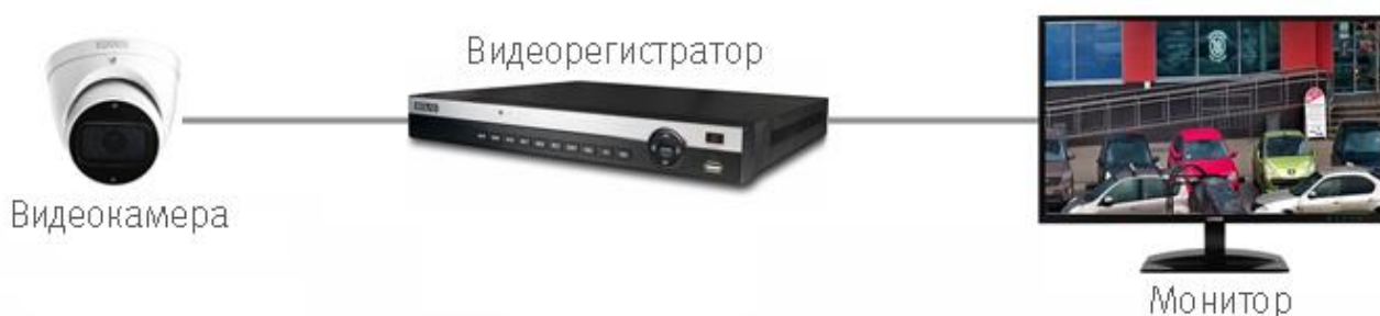
Рисунок 6.2 – Схема подключения видеокамеры
