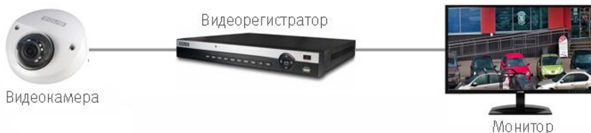
Рисунок 6.2 – Схема подключения видеокамеры
