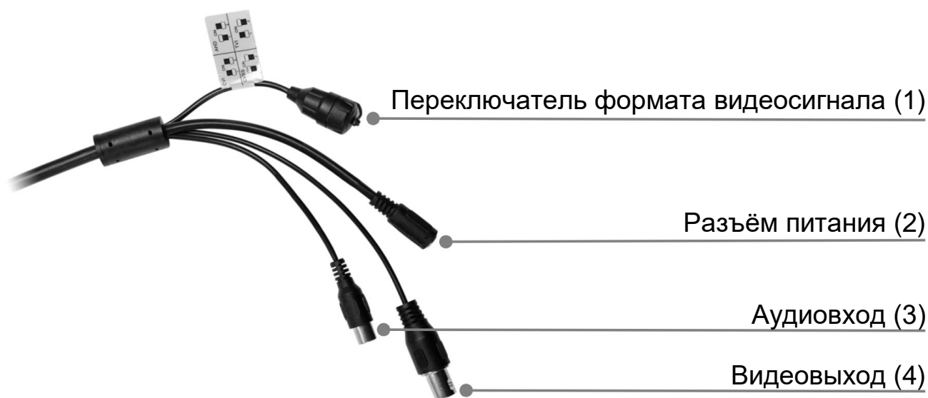
Рисунок 6.1 – Концевая раскладка кабеля видеоканеры
