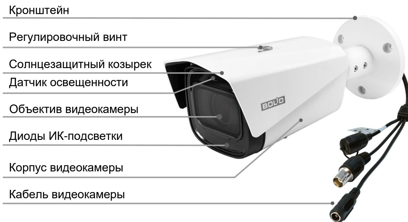
Рисунок 4.1 – Внешний вид и основные элементы видеокамеры
