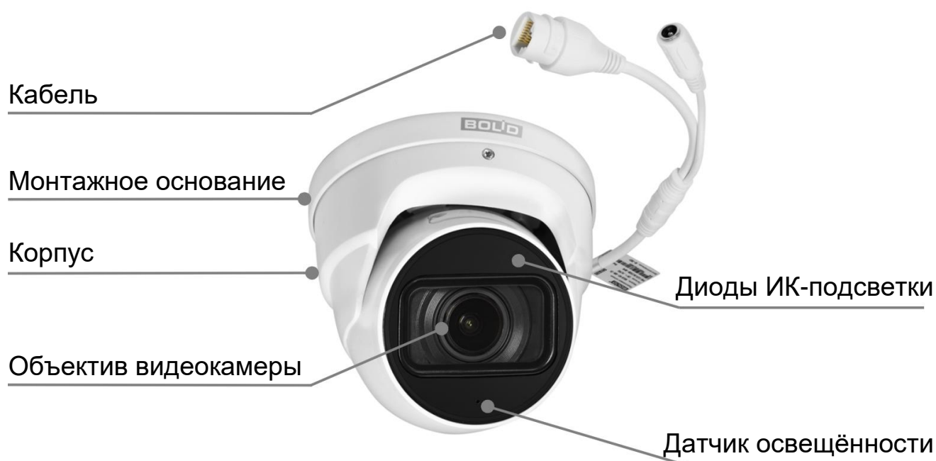
Рисунок 4.1 – Внешний вид и основные элементы видеокамеры
