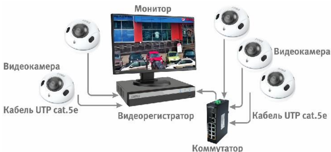
Рисунок 6.4 – Схема подключения видеокamеры к видеорегистратору
