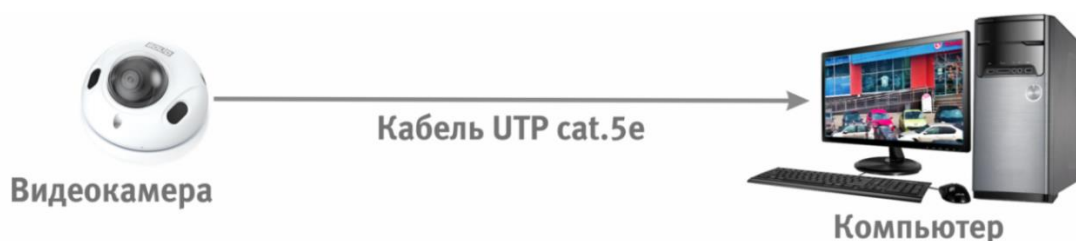
Рисунок 6.2 – Схема подключения видеокамеры к компьютеру
