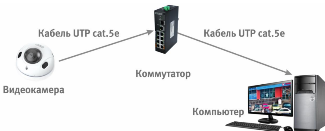
Рисунок 6.3 – Схема подключения видеокamеры к компьютеру через коммутатор
