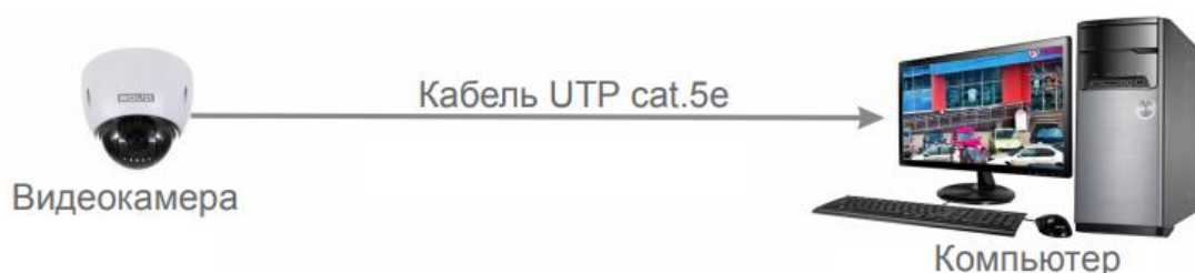
Рисунок 6.2 – Схема подключения видеокамеры к компьютеру
