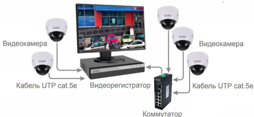
Рисунок 6.4 – Схема подключения видеокмеры к видеорегистратору
