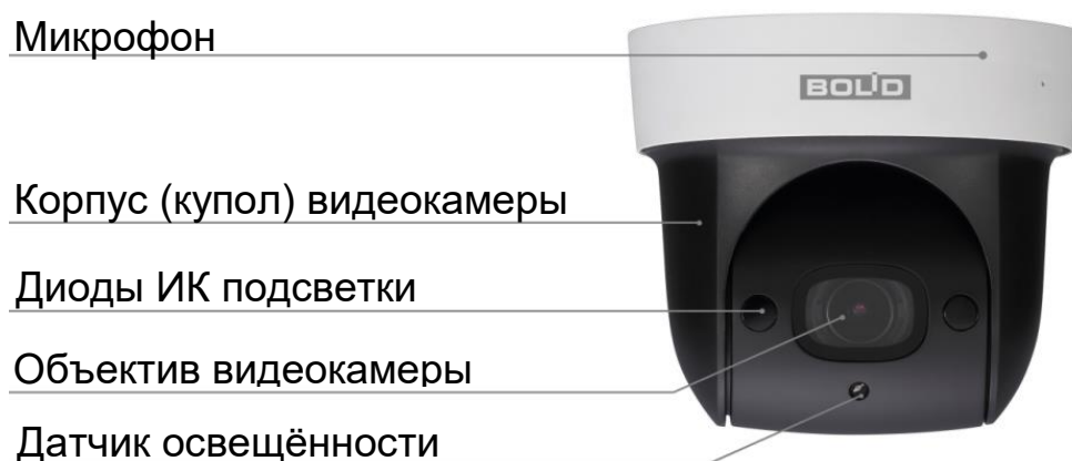
Рисунок 4.1 – Внешний вид и основные элементы видеокамеры
