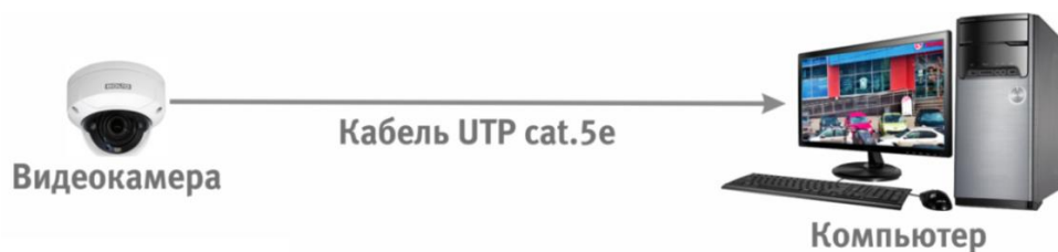
Рисунок 6.2 – Схема подключения видеокамеры к компьютеру
