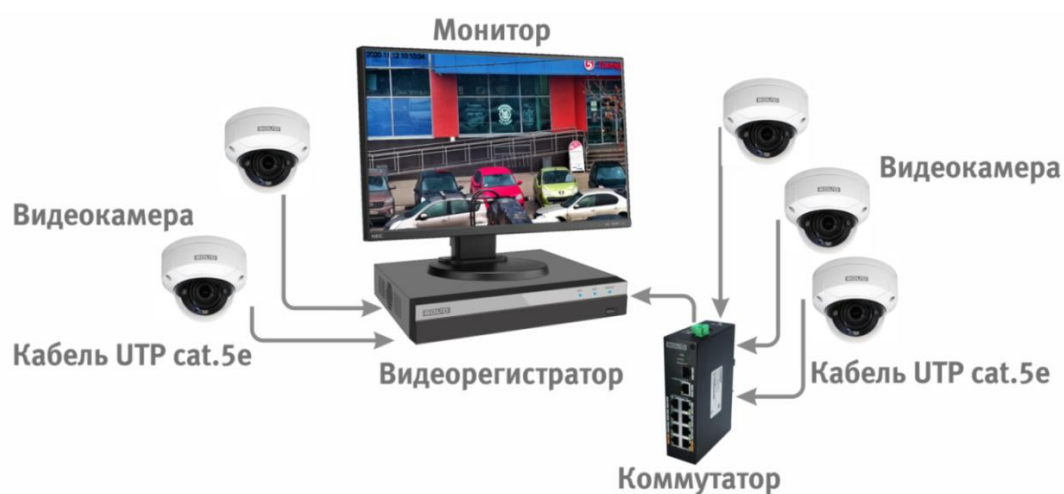
Рисунок 6.4 – Схема подключения видеокамеры к видеорегистратору
