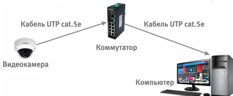
Рисунок 6.3 – Схема подключения видеокамеры к компьютеру через коммутатор
