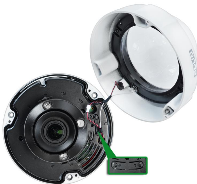
Рисунок 5.15 – Настройка фокусного расстояния вручную
