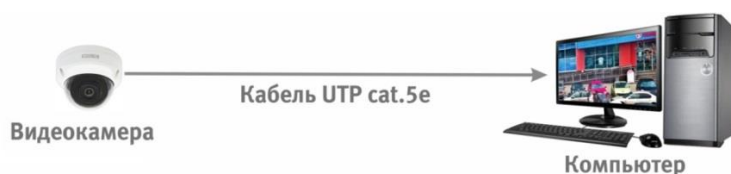
Рисунок 6.2 – Схема подключения видеокamеры к компьютеру
