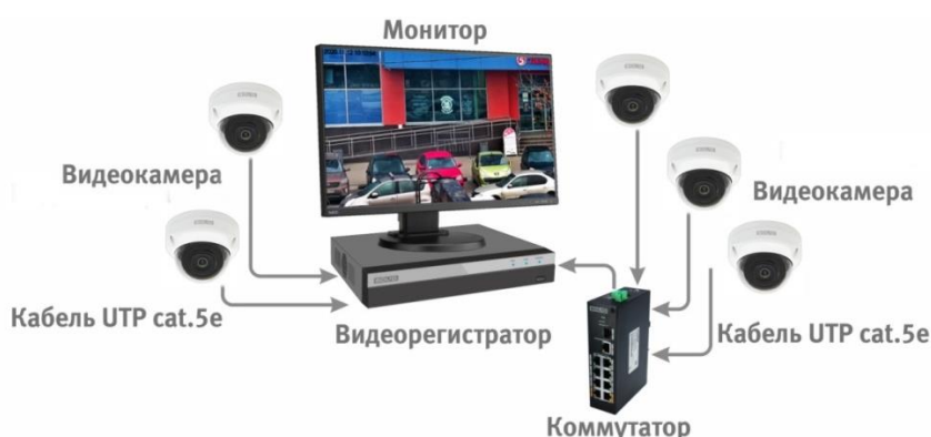
Рисунок 6.4 – Схема подключения видеокamеры к видеорегистратору
