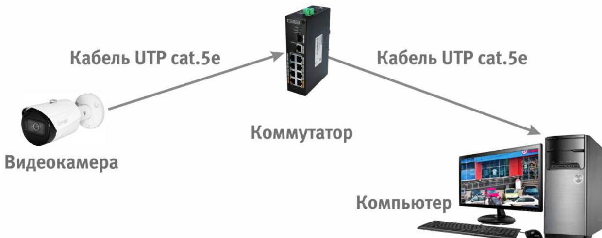
Рисунок 6.3 – Схема подключения видеокамеры к компьютеру через коммутатор
