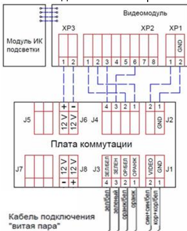
Рисунок 4.4 – Схема подключения камеры с питанием по PoE
