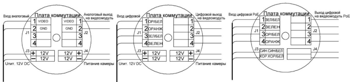
Рисунок 4.3 – Схема подключения термокожуха
