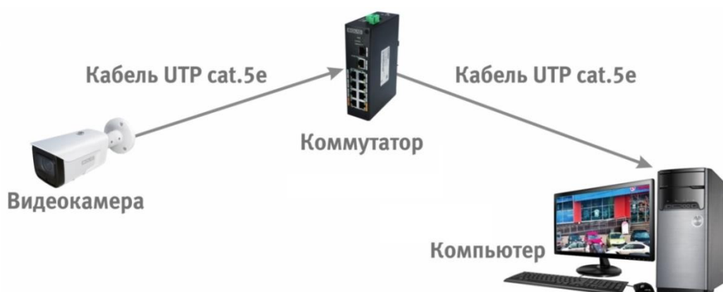
Рисунок 6.3 – Схема подключения видеокамеры к компьютеру через коммутатор
