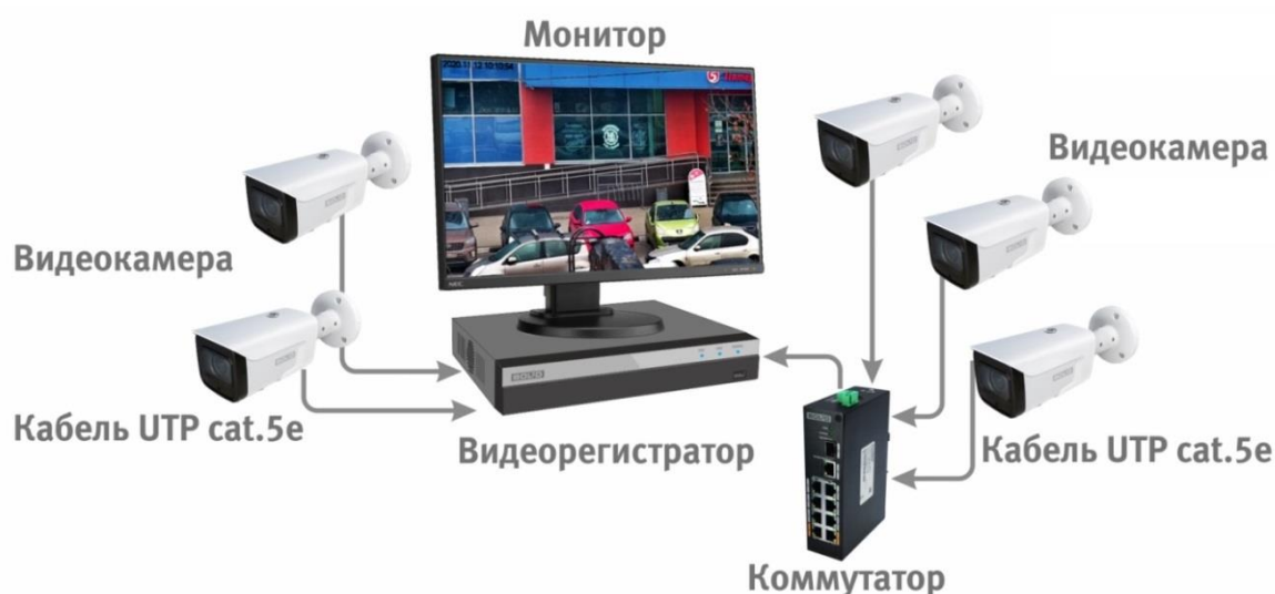
Рисунок 6.4 – Схема подключения видеокamеры к видеорегистратору
