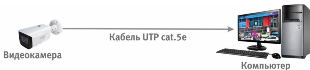
Рисунок 6.2 – Схема подключения видеокамеры к компьютеру
