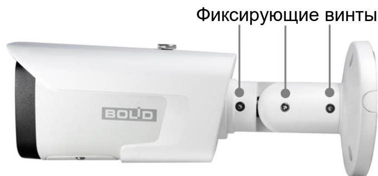
Рисунок 5.14 – Настройка направления объектива
