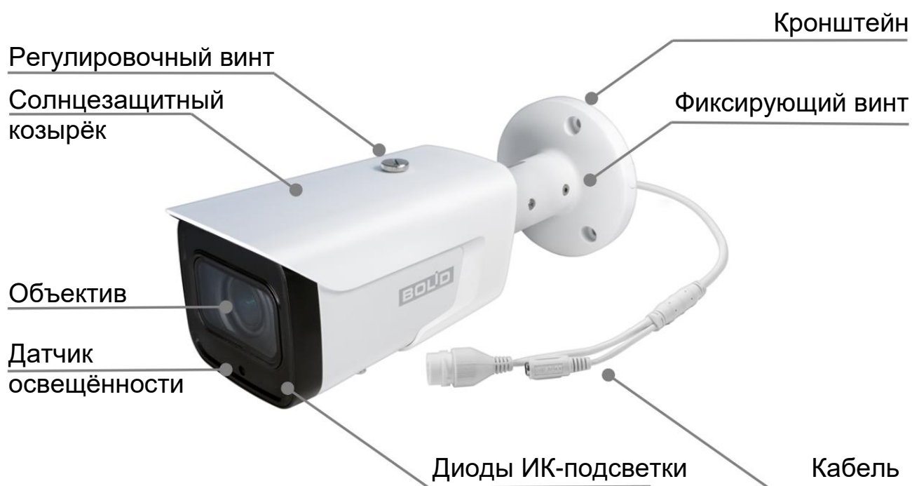
Рисунок 4.1 – Внешний вид и основные элементы видеокамеры
