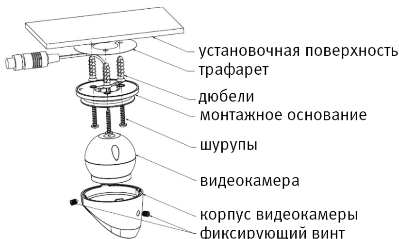
Рисунок 4.2 – Монтаж видеокамеры
