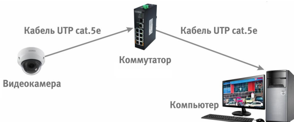
Рисунок 6.3 – Схема подключения видеокамеры к компьютеру через коммутатор
