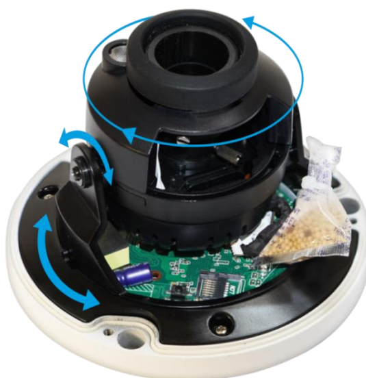
Рисунок 5.12 – Настройка направления объектива
