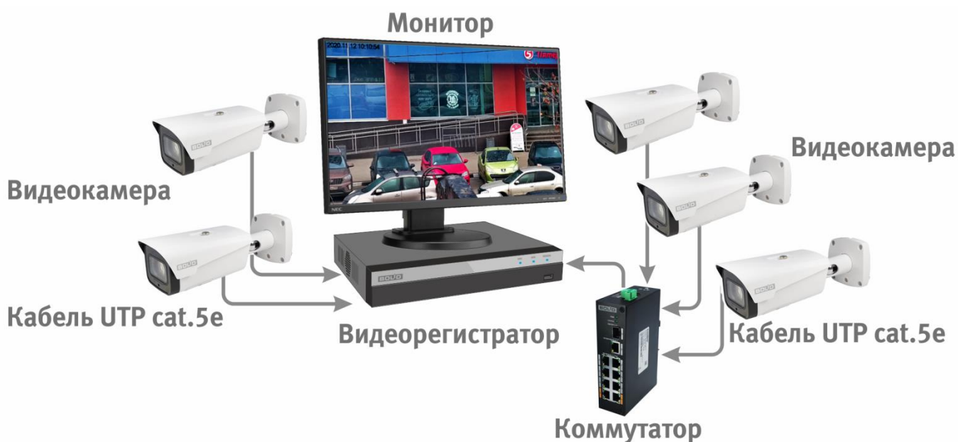
Рисунок 6.5 – Схема подключения видеокамеры к видеорегистратору
