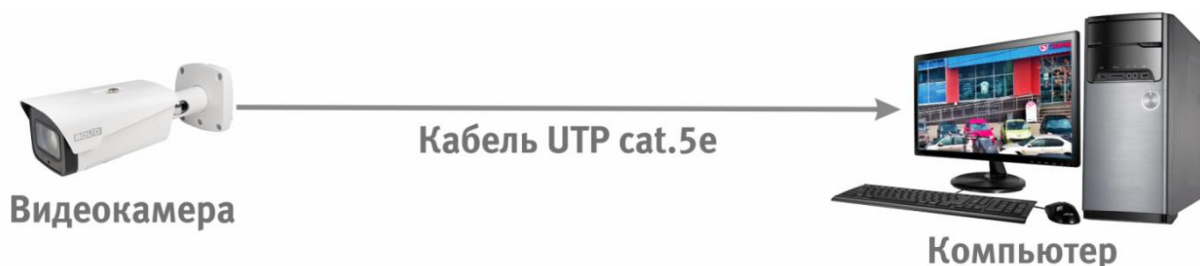
Рисунок 6.3 – Схема подключения видеокамеры к компьютеру
