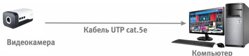
Рисунок 8.2 – Схема подключения видеокамеры к компьютеру
