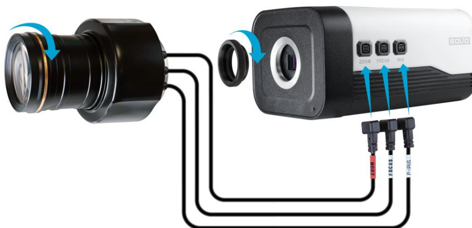
Рисунок 5.2 – Присоединение объектива типа С
