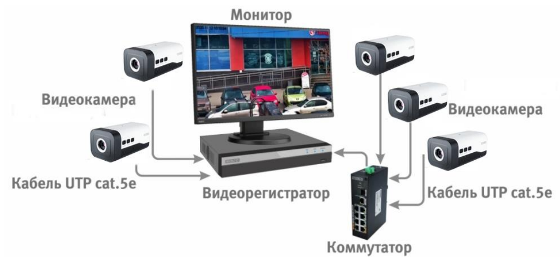
Рисунок 8.4 – Схема подключения видеокamеры к видеорегистратору
