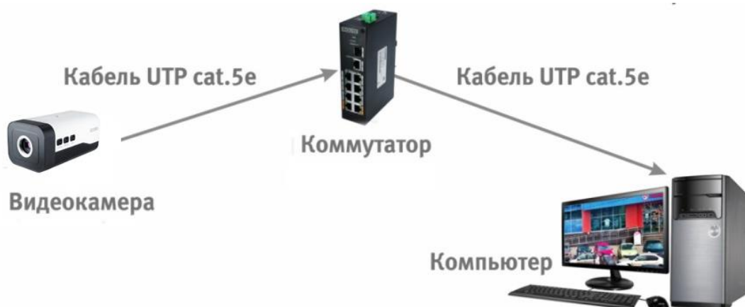
Рисунок 8.3 – Схема подключения видеокамеры к компьютеру через коммутатор
