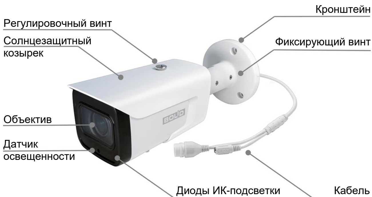
Рисунок 4.1 – Внешний вид и основные элементы видеокамеры
