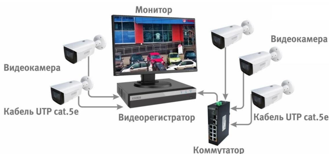
Рисунок 6.4 – Схема подключения видеокамеры к видеорегистратору
