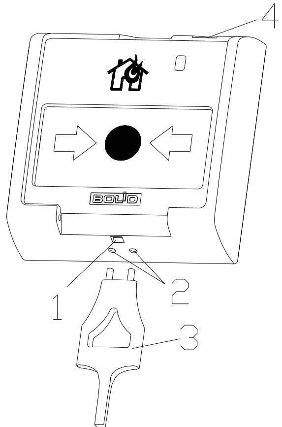
**Рисунок 2.2.3.1 Части конструкции ИПР**
