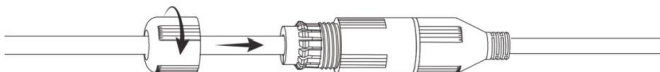
Рисунок 6.10 – Совмещение колпачка с основанием герметичной кабельной муфты
