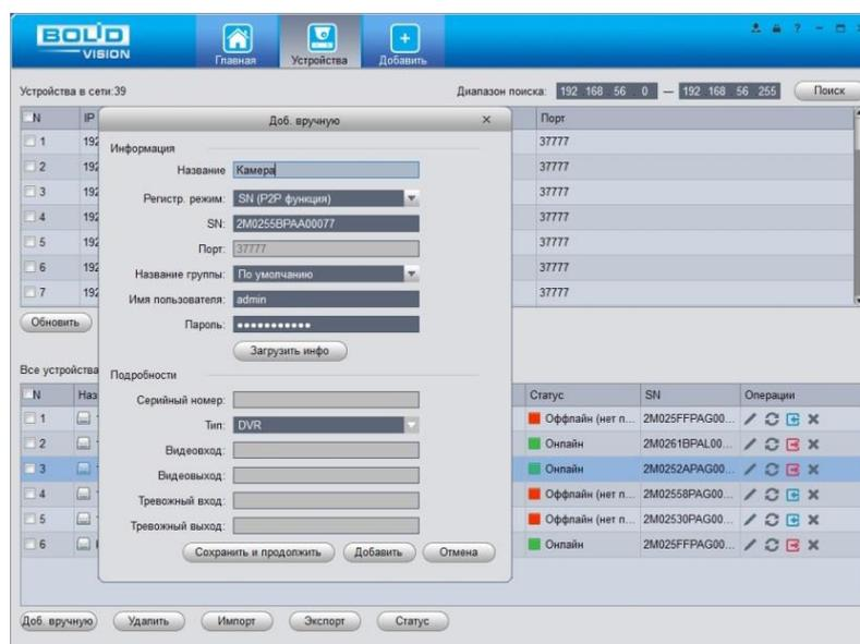
Рисунок 10.2 – Раздел «Добавление устройства» через программу «BOLID VISION»
