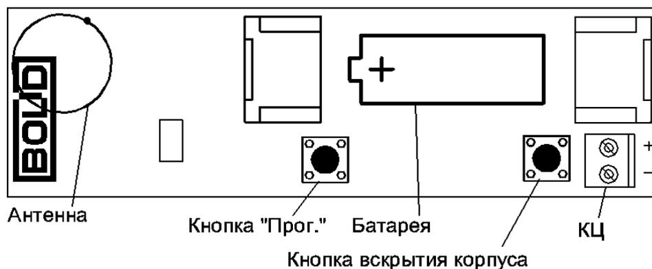
Рисунок 2.2 Расположение элементов на плате
