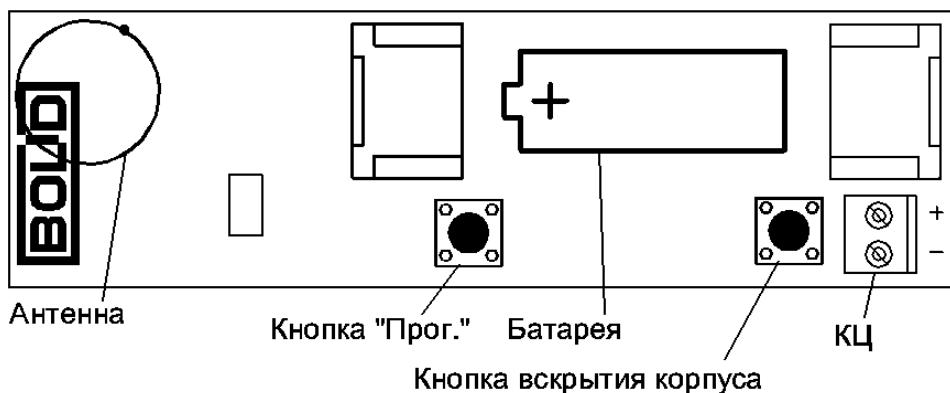
Рисунок 2.2 Расположение элементов на плате
