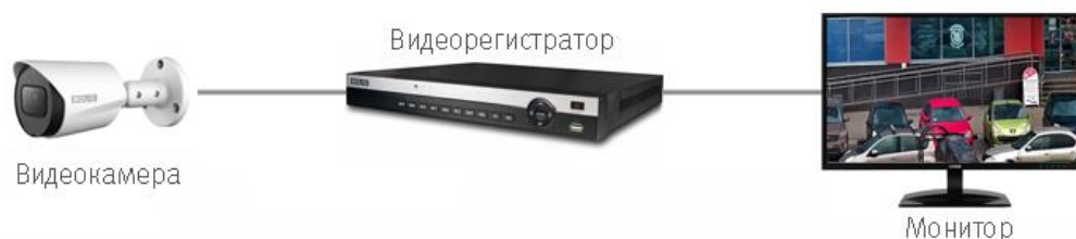
Рисунок 6.2 – Схема подключения видеокамеры
