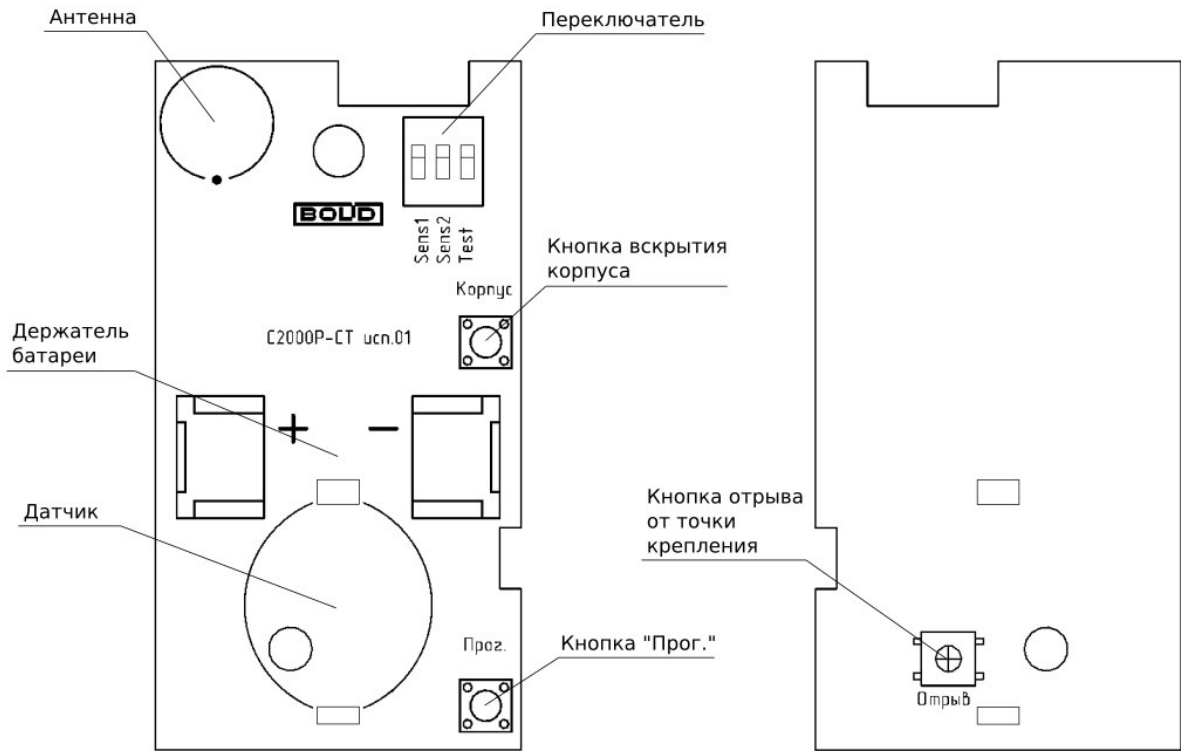
Рисунок 2.2 Расположение элементов на плате
