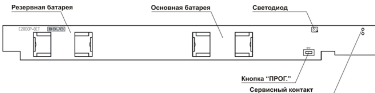
Рисунок 2.3 Расположение элементов на плате аппаратной версии 2.0
