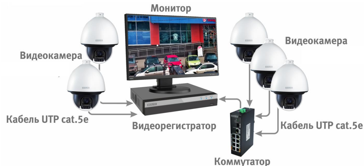
Рисунок 6.4 – Схема подключения видеокамеры к видеорегистратору
