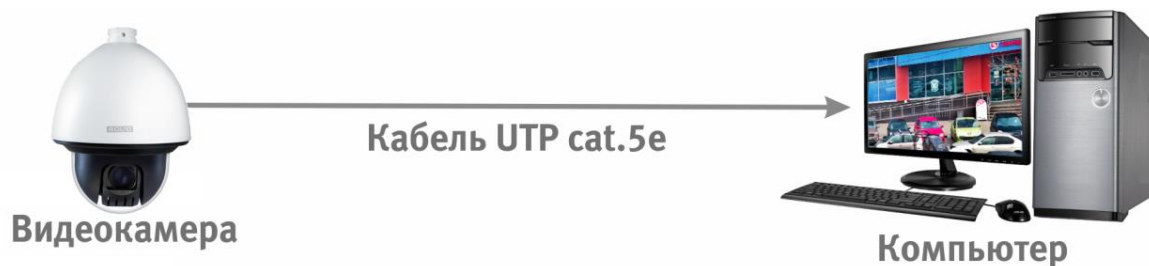
Рисунок 6.2 – Схема подключения видеокамеры к компьютеру
