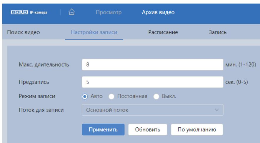
Рисунок 7.93 – Вкладка «Настройка записи»
