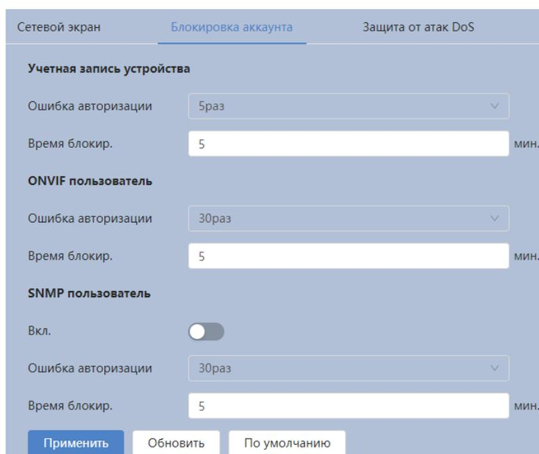
Рисунок 7.112 – Вкладка «Блокировка аккаунта»
