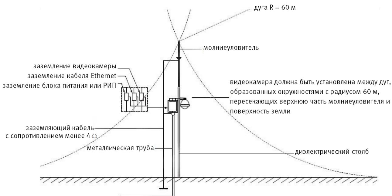
Рисунок 6.13 – Установка молниеотвода
