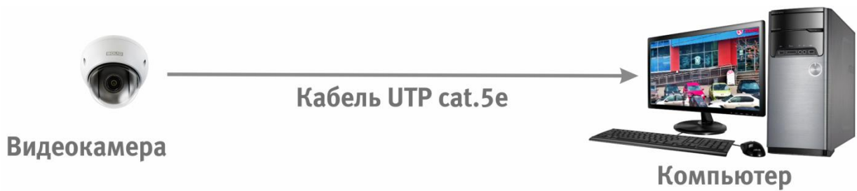
Рисунок 6.2 – Схема подключения видеокамеры к компьютеру
