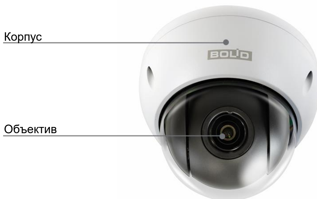
Рисунок 4.1 – Внешний вид и основные элементы видеокамеры
