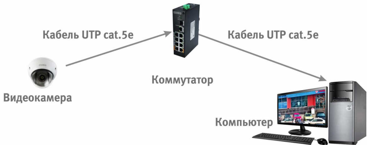
Рисунок 6.3 – Схема подключения видеокамеры к компьютеру через коммутатор
