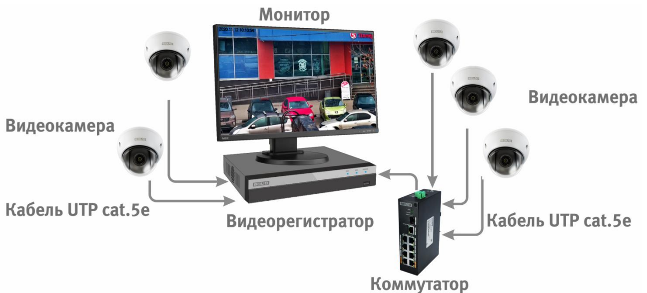
Рисунок 6.4 – Схема подключения видеокамеры к видеорегистратору
