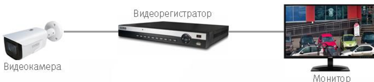
Рисунок 6.2 – Схема подключения видеокамеры
