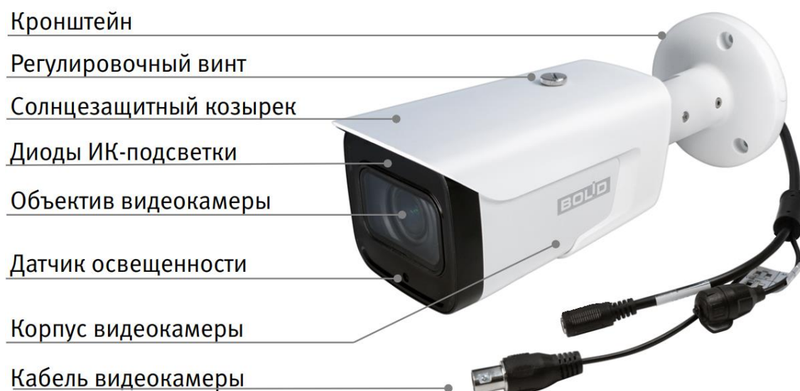
Рисунок 4.1 – Внешний вид и основные элементы видеокамеры
