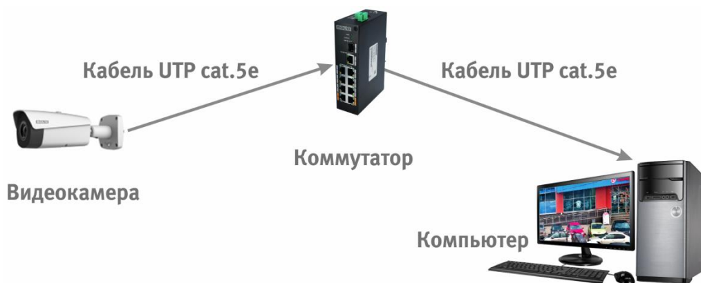
Рисунок 5.3 – Схема подключения видеокмеры к компьютеру через коммутатор
