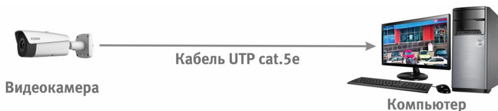
Рисунок 5.2 – Схема подключения видеокamеры к компьютеру
