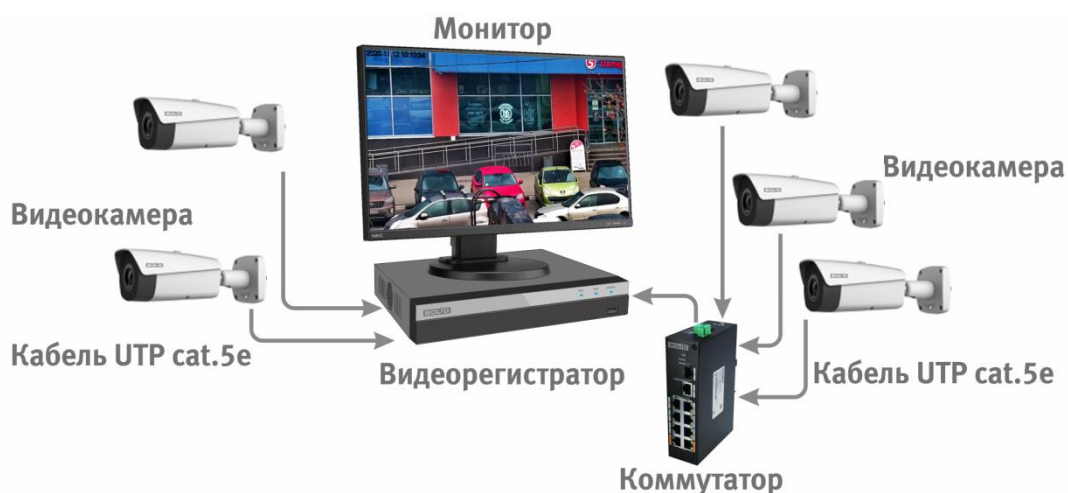
Рисунок 5.4 – Схема подключения видеокмеры к видеорегистратору
