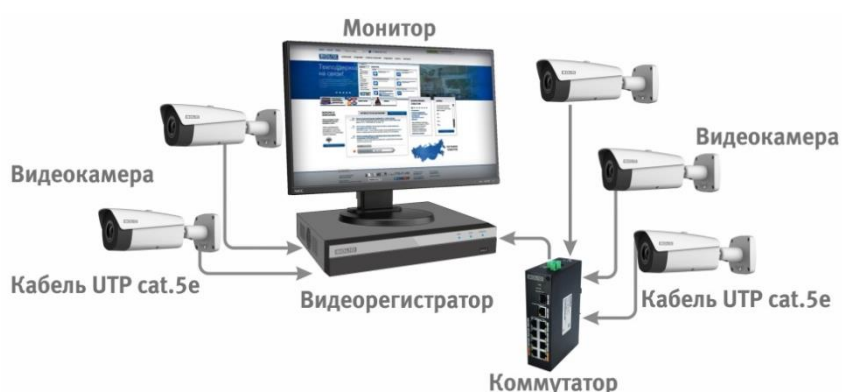
Рисунок 5.4 – Схема подключения видеокamеры к видеорегистратору
