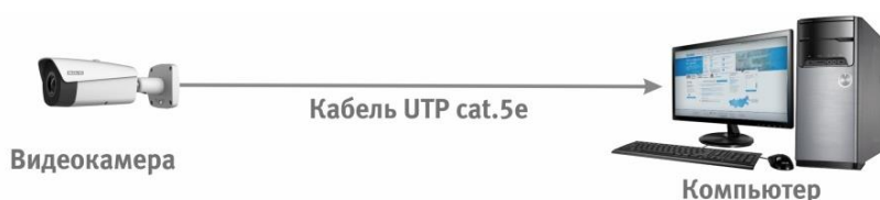
Рисунок 5.2 – Схема подключения видеокamеры к компьютеру
