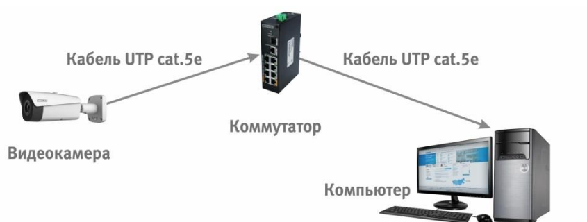
Рисунок 5.3 – Схема подключения видеокamеры к компьютеру через коммутатор
