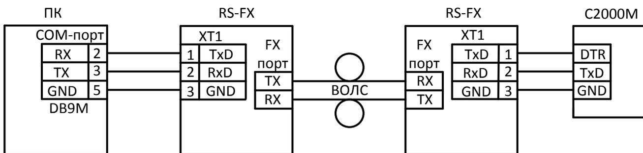
**Рисунок 2.2.4** Схема подключения в режиме удлинения RS-232
