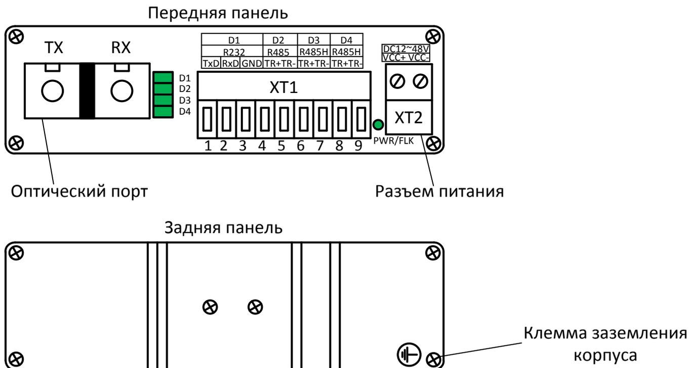
**Рисунок 2.2.1** Внешний вид преобразователя
