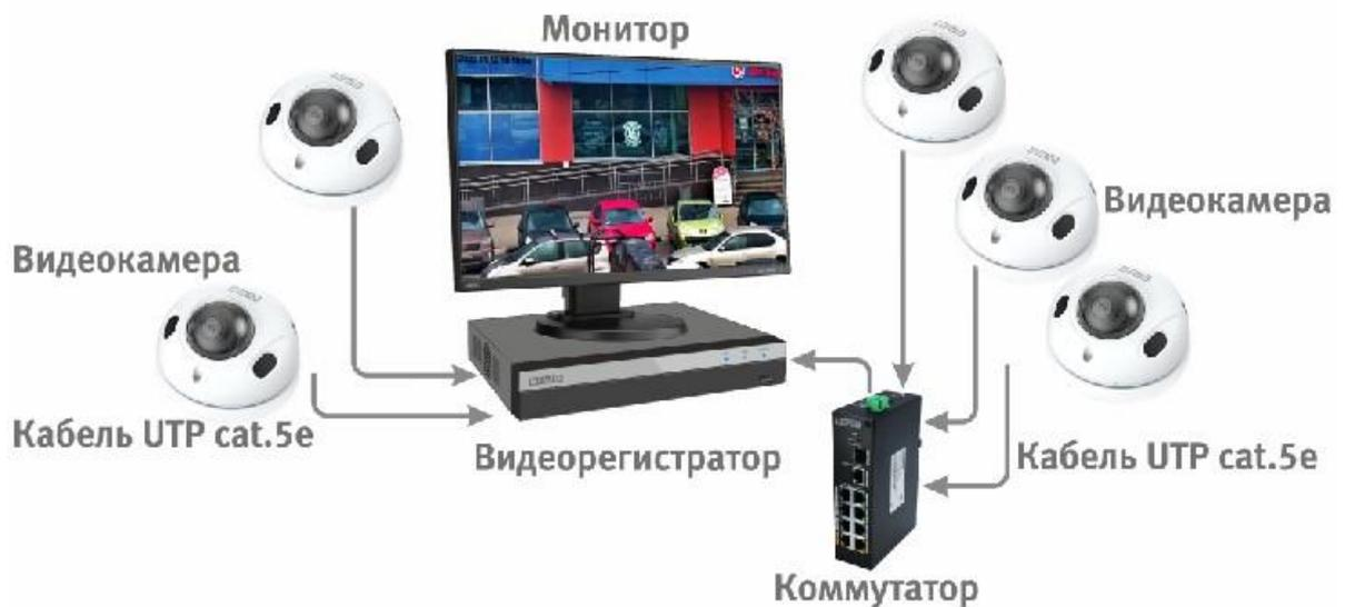
Рисунок 6.4 – Схема подключения видеокамеры к видеорегистратору
