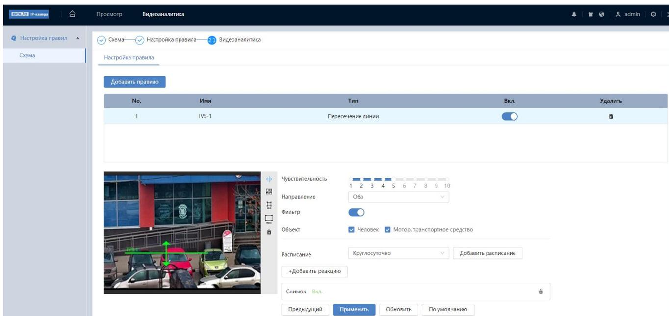
Рисунок 7.19 – Создание правила видеоаналитики «Пересечение линии»
