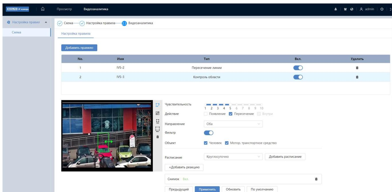
Рисунок 7.20 – Создание правила видеоаналитики «Контроль области»
