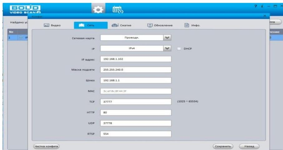
Рисунок 13.2 – Изменение IP-адреса видеочамеры с помощью утилиты «BOLID VideoScan»
