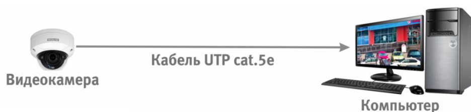
Рисунок 6.2 – Схема подключения видеочамеры к компьютеру
