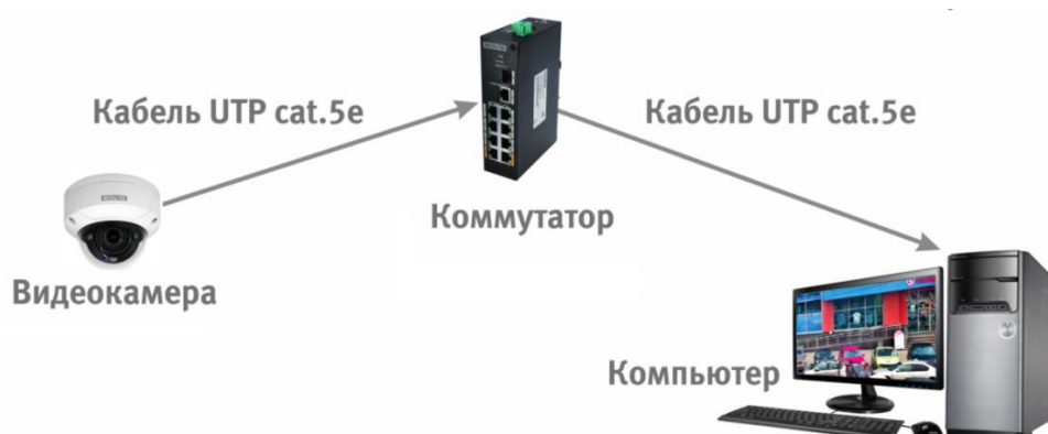
Рисунок 6.3 – Схема подключения видеочамеры к компьютеру через коммутатор
