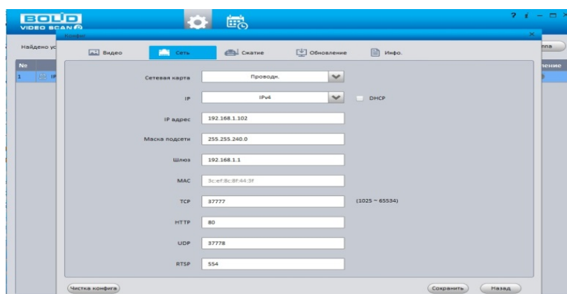
Рисунок 28.2 – Изменение IP-адреса с помощью утилиты «BOLID VideoScan»
