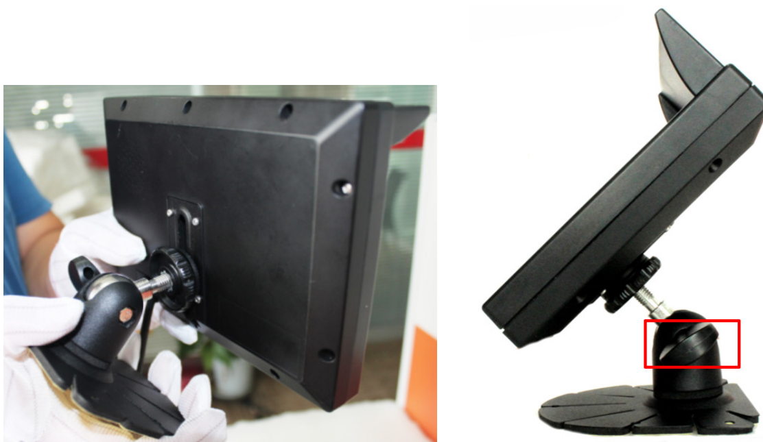
Рисунок 4.3 – Крепление монитора к кронштейну
