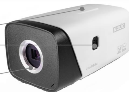
Рисунок 4.1 – Внешний вид и основные элементы видеокамеры
