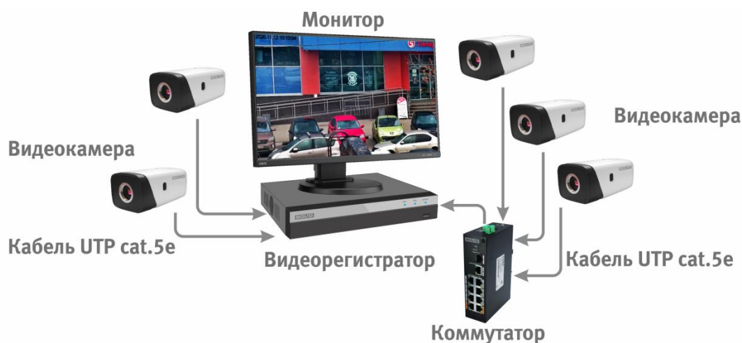
Рисунок 8.4 – Схема подключения видеокамеры к видеорегистратору
