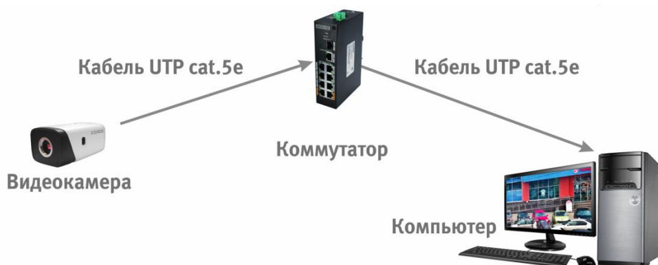
Рисунок 8.3 – Схема подключения видеокамеры к компьютеру через коммутатор
