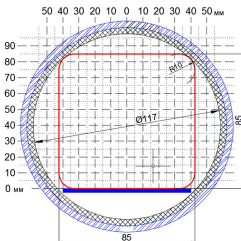
Рисунок 4.4 – Сечение термокожуха
